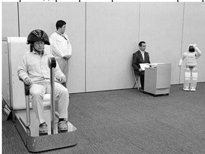
Рис. 1.7. В лаборатории Honda Motor. Испытание системы чтения мыслей для робота Asimo. Фото с сайта engadget.com
